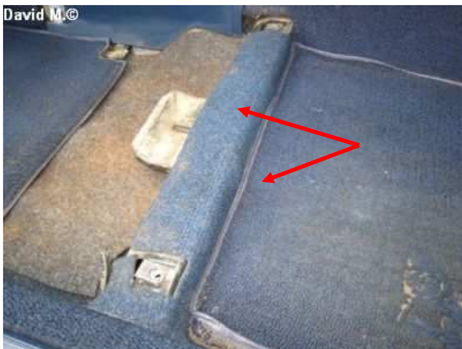
46) Fahrersitzkonsole mit Filzteppich verkleidet, vordere Teppiche nicht auf Sitzkonsole geclipst
