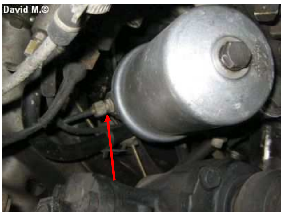
61) Öldruckleitung am Filtergehäuse mit Überwurfmutter befestigt; andere Position
