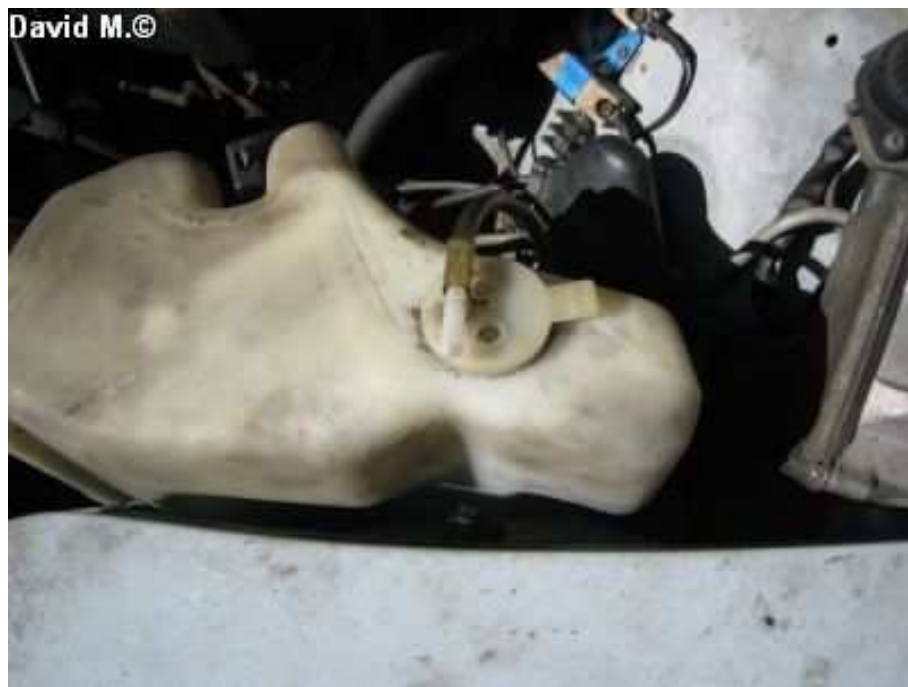
57) Einfülldeckel für Waschwasser kleiner, andere Position
