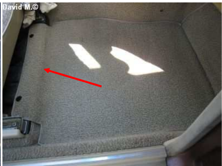
46) Fahrersitzkonsole mit Filzteppich verkleidet, vordere Teppiche nicht auf Sitzkonsole geclipst
