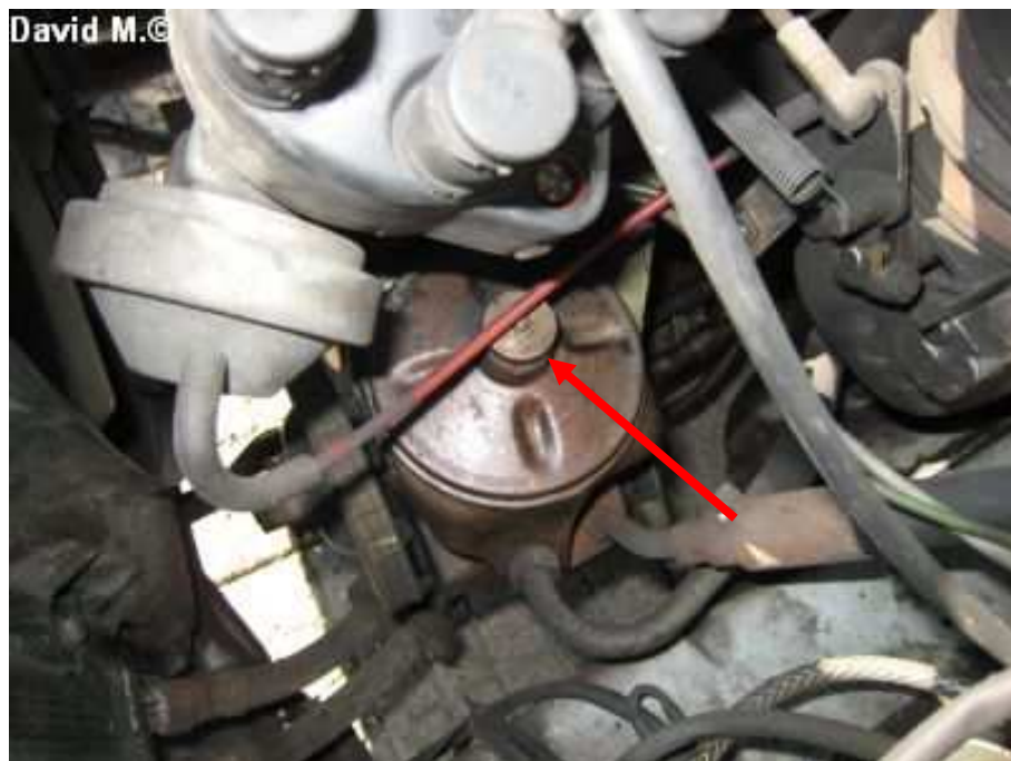
58) Deckel der Servopumpe mit Rändelmutter statt Flügelmutter
