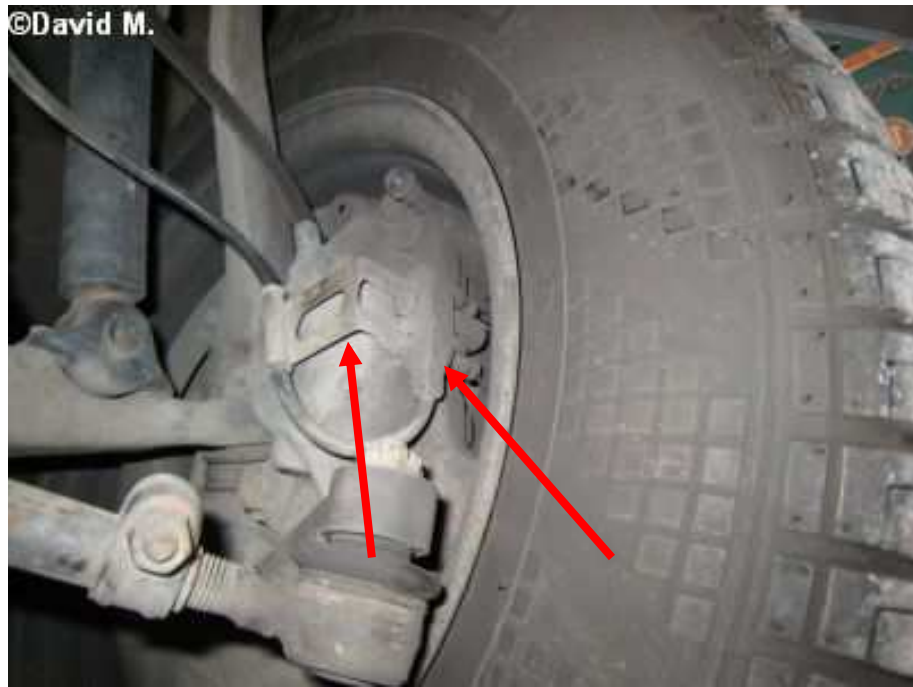
60) andere Verschleißanzeige; Kabel mit Blechhalter am Bremssattel
